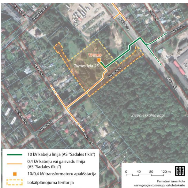
46.att. Elektroapgāde apkārtnes kontekstā, esošā situācija
