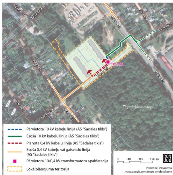
47.att. Elektroapgāde - plānotā situācija, principiālais
