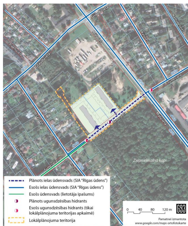
41.att. Ūdensapgāde - plānotā situācija, principiālais risinājums
