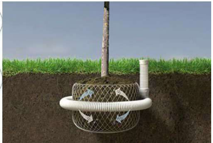
Pav.4 Principinė aeravimo sistemos schema
